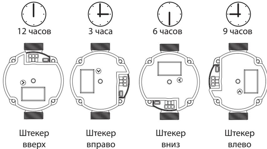
корпус электромотора к корпусу насоса и, повернув корпус электромотора на желаемый угол, снова крепко затянуть 4 винта соблюдая последовательность «крест-накрест» – т.е. затягивая винты сначала по одной диагонали, а затем по другой. При этом внутри насоса не должно быть давления жидкости – для этого необходимо или опорожнить трубопроводы, или перекрыть оба отсекающих крана – до и после насоса, как показано на рисунке выше.
