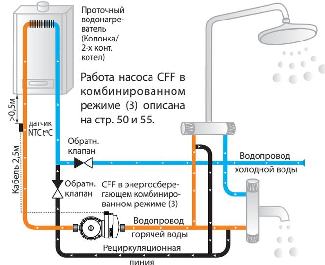
**Примечание:** данная схема требует прокладки отдельного рециркуляционного трубопровода, но при этом горячая вода никогда не подмешивается в холодную при работе рециркуляционного насоса.
