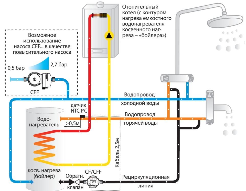
Примечание: в качестве примера на схемах показан возможный вариант использования насоса модели CFF... (со встроенным датчиком протока) в качестве автоматического повысительного насоса, повышающего давление в водопроводе до комфортного уровня.
