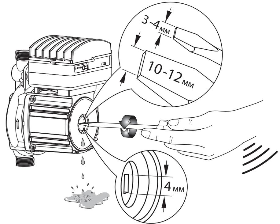
**i** При отворачивании пробки возможно вытекание небольшого количества жидкости – это не критично, жидкости не вытечет много даже если насос находится под давлением.
