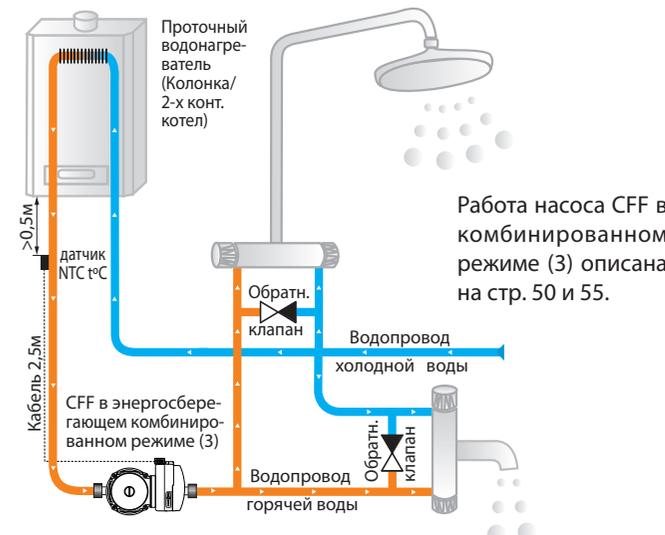
**Примечание:** данная схема позволяет сэкономить на прокладке отдельного рециркуляционного трубопровода, однако она имеет следующую особенность: при открытии крана холодной воды во время работы рециркуляционного насоса, горячая вода может быть частично подмешана в холодную.
