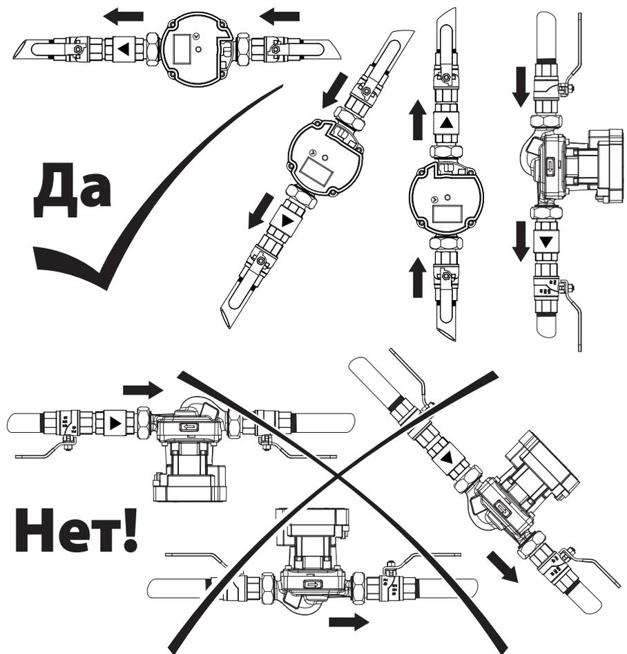
При условии горизонтальности оси вала, направление течения рабочей жидкости может быть любым – снизу вверх, сверху вниз, горизонтально или под любым уклоном.
