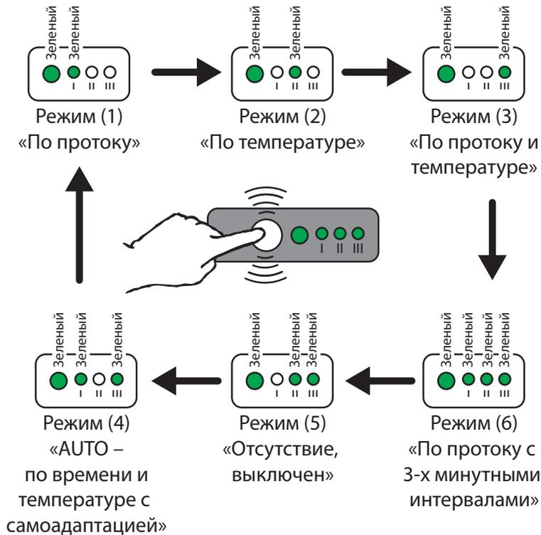
«По температуре» только тогда, когда это необходимо (за 30 минут «до» и в течение 1 часа «после» запомненного ранее времени начала водоразбора горячей воды), в остальное же время насос будет выключен, и как электроэнергия, затрачиваемая рециркуляционным насосом, так и тепловая энергия на нагрев воды в водонагревателе, не будут расходоваться «впустую».
