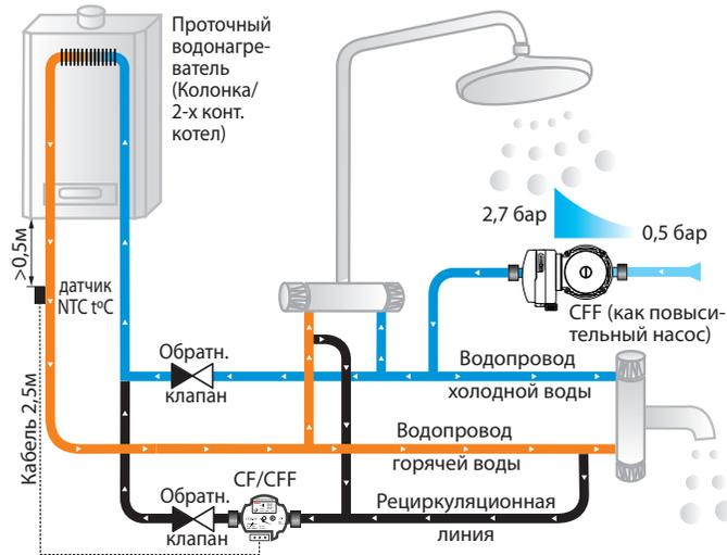
**Примечание:** данная схема требует прокладки отдельного рециркуляционного трубопровода, но при этом горячая вода никогда не подмешивается в холодную при работе рециркуляционного насоса.
