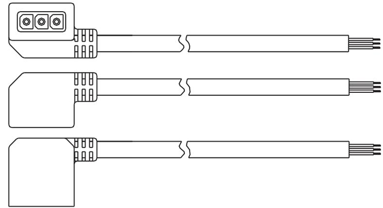
Проложите и закрепите электрокабель, идущий в комплекте поставки насоса (рис. вверху) таким образом, чтобы он свободно и без натяжения подходил к штекеру подключения насоса. Электрокабель не должен касаться горячей поверхности трубопроводов, острых кромок и пр.
