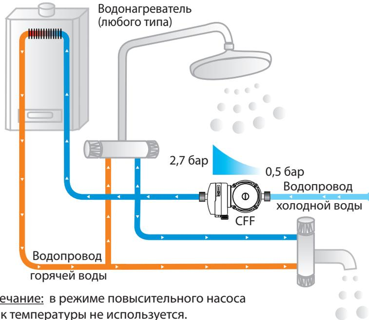
Примечание: в режиме повысительного насоса датчик температуры не используется.
